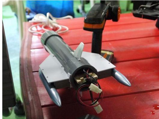
内部構造はいたってシンプルで、軸先部分にサーボが逆さまに固定されている他は、受信機、アンプ、バッテリーが詰め込まれている。
