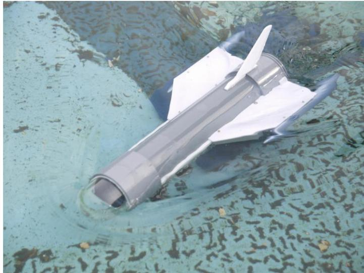
子供のおもちゃとして、「完全防水(浸水による沈没無し)」「潜水できるが潜りすぎない」「手荒に扱っても壊れない」ことを目標に、ラジコン潜を製作した。
