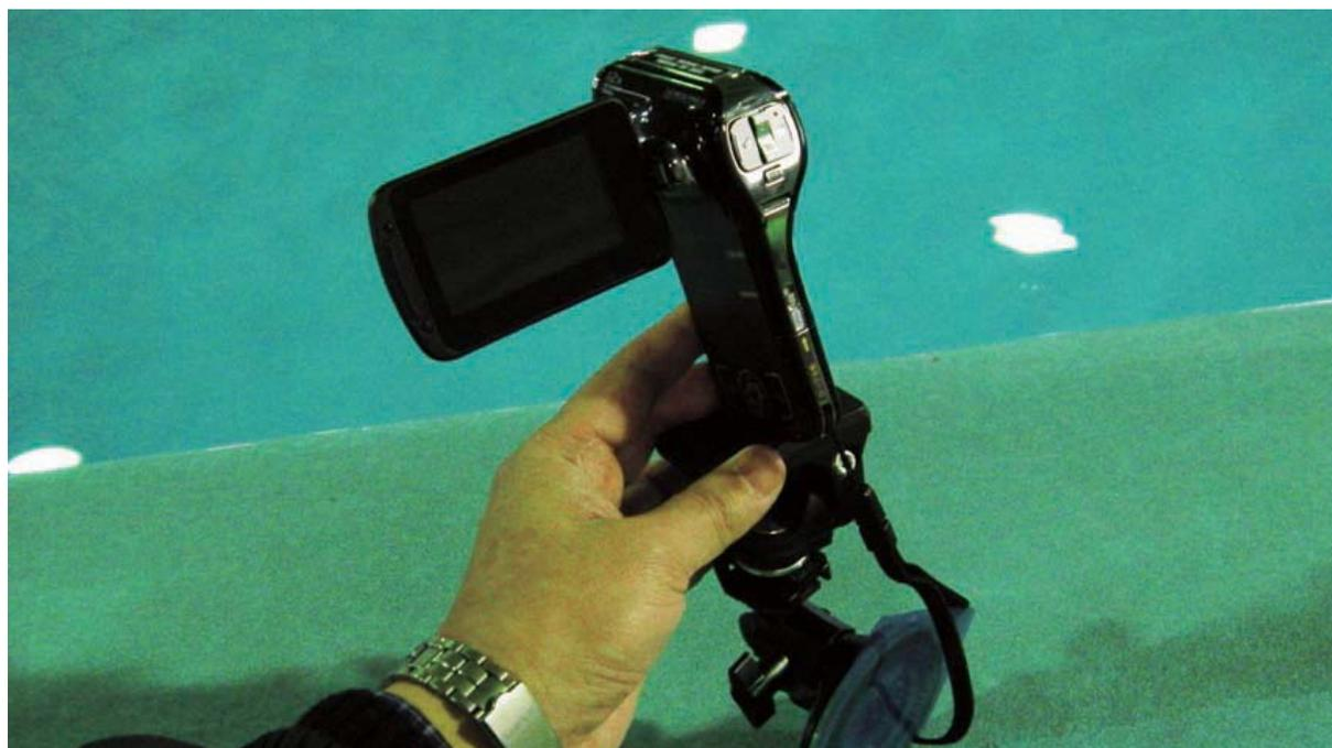
カーナビ設置用の吸盤で固定しますが、自由に方向を動かすためにカメラ雲台を加工して保持具に取り付けてそこにカメラを固定します。
