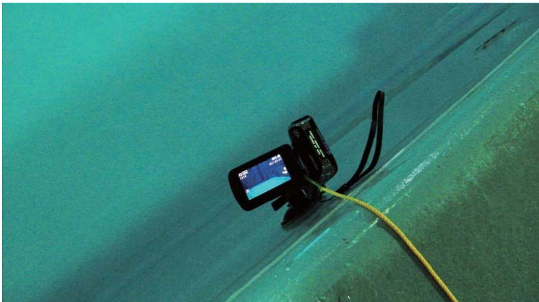
プール壁面に吸盤で固定したWA10カメラ。モニターが上を向くため水上からの映像確認が可能。また、水中でもズーム操作も可能です。
