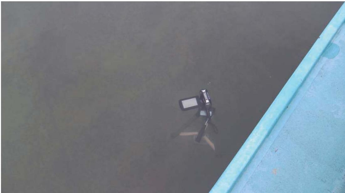
屋外プールでは壁面に吸盤固定はできないため三脚につけて沈めます。このときも水上から撮影範囲が確認できますし、撮影中もどう映るのが確認できるのでほぼ失敗なく撮影可能です。
