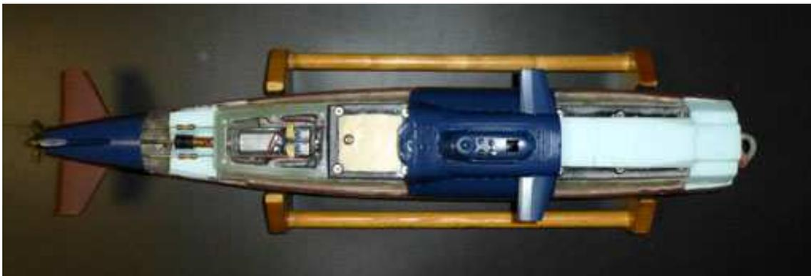
ポンプを動かし喫水を下げて行きます。下に連続写真を示します。一番上が水タンクが空の状態です。徐々に水タンクに注水して喫水を下げて行きます。上から5番目が水タンクを満水にした状態です。セールの中程まで喫水が来ています。ピストン・バラスト装置のシリンダ容積から満水時の喫水がもう少し下でも可能ですが、浮力材を入れるスペースが無いのでこれでOKとします。写真の一番下が着底させた状態ですが、ここでもう一つの失敗が明らかとなりました。それはピストン・バラスト装置の給水口を水タンク内にしたことです。水タンクの開口部はセールの頂上で、ポンプで注水しないと水が入らない構造になっています。ピストンを動かして水タンクの容積を変えても、ポンプが動いていなければ水タンク内の水量は変わりません。実に馬鹿げたミスです。ピストン・バラストの給水口は耐圧容器の外部にする必要がありました。今回は仕方が無いので、ピストンとポンプを同時に動かすことにしました。
