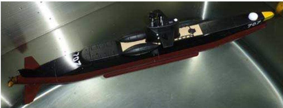
ポンプバラストシステムを搭載することにより、浮上時に甲板を水上に出すことが出来、更にどのような動きをしても常に水平を保つことが出来る「サブマリン 707」を手に入れることが出来ましたが、潜航までの時間が長いこと（約 1 分）とポンプの漏れで静止状態で同じ深さに留まれないと言った課題が残りました。電磁弁を付けるスペースは無いので、この辺りは我慢するしかありません。また密閉室の内容積が 1300cc 程度であるのに対し、比較的大きな 240cc のタンクは最大密閉室内を 18%程度加圧します。水密室の蓋は外圧に対しては押し付けられる方向であり水密を保ち易いですが、内圧に対しては弱く漏
