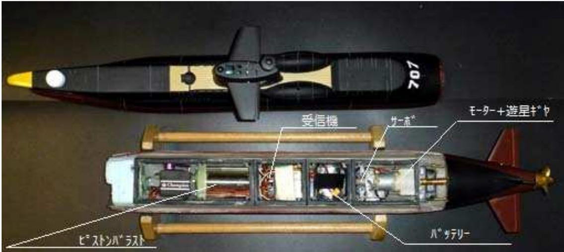
本システムの課題は、浮上時水面に出ている部分の質量が 72g と小さいことで、下の写真のように甲板は完全に水没しています。水中静止は出来ませんが水上航行時の状態がダイナミック・ダイブ方式と変わらず美しくありません。
