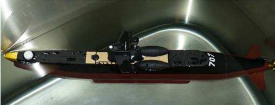
本システムの課題は、潜りながら（下向きで）注水すると、ベント弁が注水室の平らな蓋の真ん中に付いている関係で、注水室の空気が完全には抜けず空気溜りができてビークル後部を空中に突き出してしまうと言うものです（下写真）。
