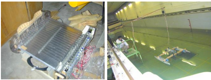
図7 モデル1：左が機構部、右が双胴船につけた自航試験ヒレ端部 Z_0 = A_0 \sin(2\pi NT - 3\pi(X/L)) L :ヒレ長
