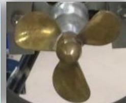
ブラシレスDCモータを剥き出し状態で4機設置し、サージ、ヒープ、ヨー、ロールの4自由度を制御。
