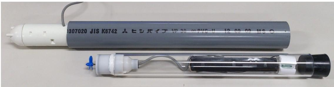
図 5、試作した子機発射管
