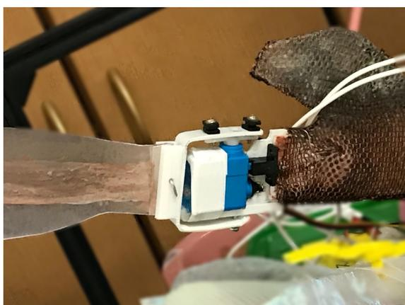
写真 尾先のみ動かす取り外し式サーボユニット内部
