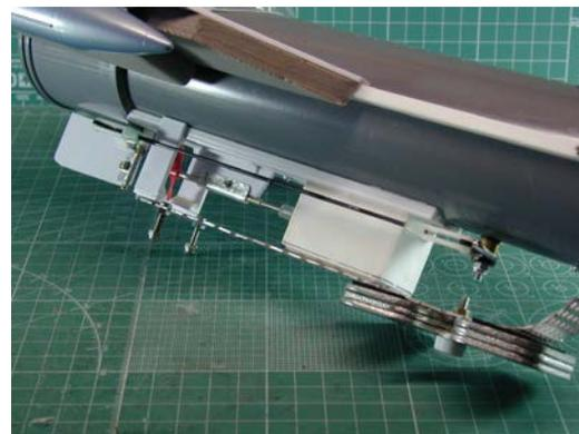
工作を簡単にするためにモーターは水密構造に加工して外に配置し、舵のリンケージもサーボモーターの軸を船体側面から外に出す構造にしている。防水に関してはこの軸の部分と、モーターの配線のみ注意すれば特に問題はない。
