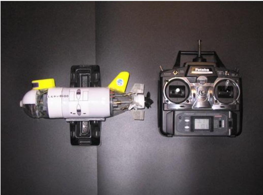
中立から少し上で潜舵が水平になるようにしたので、右スティックを一番上まで上げ潜らせたあと中立から少し上の位置まで戻せば水中を一定の深度で航行させることが出来ます。その位置より下にすれば浮上しますし、上にすれば更に深く潜ります。
