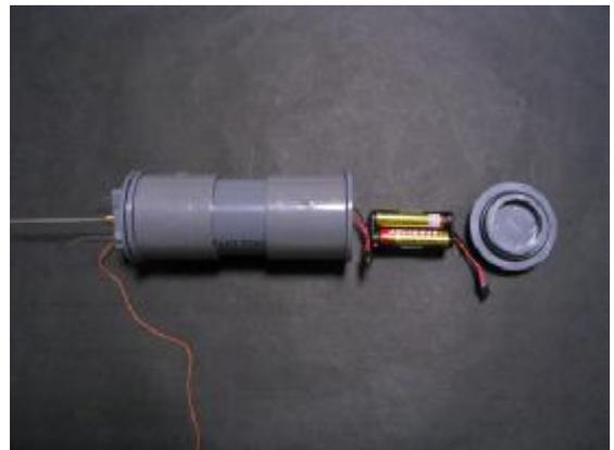
WTCにはペットボトルに固定するためのリングを取り付けます。押し込んだ状態でペットボトルの口から5mm以上奥になるようにして下さい。作例では左端から100mmの位置に内径54mm×外径68mmのリングを2mm厚のPET板から切り出し取り付けました。作例では掃除口の蓋に2mmのビスを5本付け、リングに2mmの穴を8個開けてアンテナ線を張ってあります(次ページ左の写真)。
