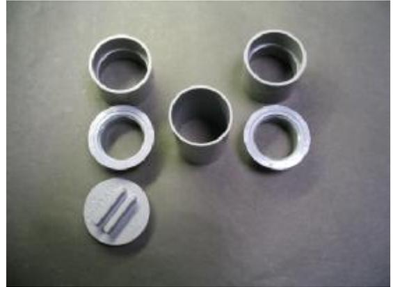
WTCの組立ては塩ビパイプ用セメダインA(低粘度品)を使いました。組む前にパイプの面取りをして置かないと奥まできちんと挿入できないので注意して下さい。接着面両面に付属のハケで手早く塗り、手で押し込んでからプラスチックハンマーで叩き込みます(下左の写真)。乾燥したら組み立てます(下右の写真)。
