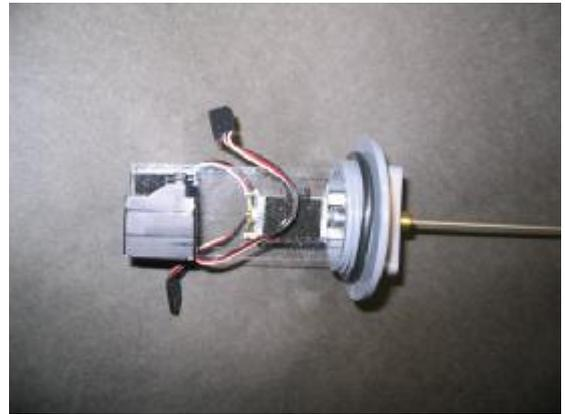
モーターの裏側に ECS を両面接着テープで固定します。受信機はその上に両面接着テープで固定しますが固定する前に ECS のコネクタをカットして S,+,- を直接受信機に半田付けします(下左の写真)。これはコネクタを 2 段重ねで設置するスペースが無いからです。配線がばらけ無い様ビニタイ及び熱収縮テープで結束しました(下右の写真)。
