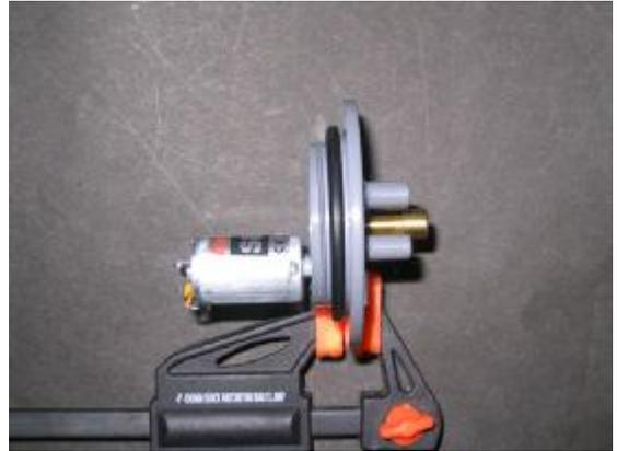
スパーギヤはレインボープロダクツの T30×0.5 モジュールを使います。シャフトは 2mm ステンレスバネ線でスパーギヤを入れる前に必ずシムを入れてください。下左の写真はモーター側から写したものです。スパーギヤとモーターの間には 2mm 厚のテフロンワッシャーを入れシャフトが下がらないようにします。
