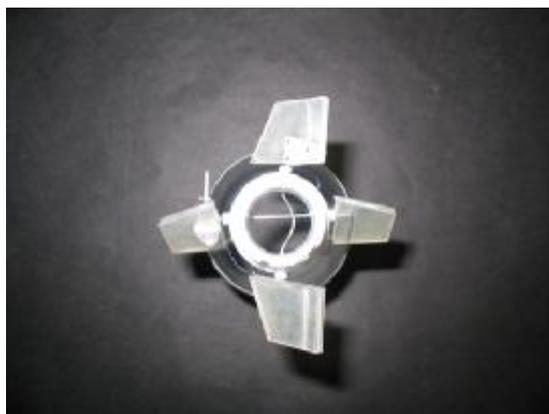
舵は底辺 30mm 上辺 20mm 高さ 20mm の台形にしました。曲げたバネ線を逃げるため 1mm 厚のプラ板をコアにして両側に 0.5mm 圧のプラ板を両面テープで貼ってあります(上右の写真)。リンケージは現物合わせで作ります。ジョイントがぶつからないようペットボトルの取り出し口は大きめに開けます。下に組み立てた写真を示します。接着は浮力調整後になりますのでまだ付けないようにして下さい。
