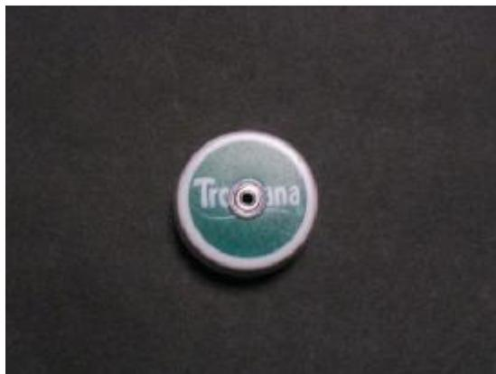
縦舵と横舵は上下、左右を内部で連結した形状を採用しました。連結は外径 1.0mm のステンレスバネ線です。縦舵はプロペラシャフトを逃げるため内部で湾曲させます。そのためバネ線をペットボトルの口の基部に 1mm の穴を開け差込んでからペットボトルの口からラジオペンチで曲げました(下左の写真)。横舵は上下にシフトできるため内部で曲げる必要はありません。作例では上側に逃げています。
