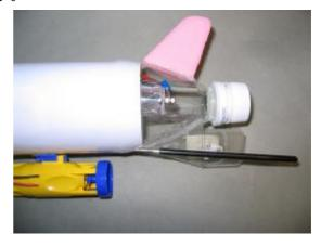
リンケージは外径 1.4mm のステンレスパイプと外径 1.0mm のステンレスバネ線を使います(次ページ 左の写真)。両方ともハンズで入手できます。ステンレスパイプは長さ 60mm にカットしてください。ドレメ ルに円盤の砥石を取り付けカットすると潰れず楽に作業ができます。ステンレスバネ線は一方の端に Z
