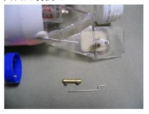
真鍮製のロッドコネクターを使ってリンケージを仮組みします(下左の写真)。この時ロッドコネクターがロッドの一番外側のマークより外側に位置するようにしてください。
