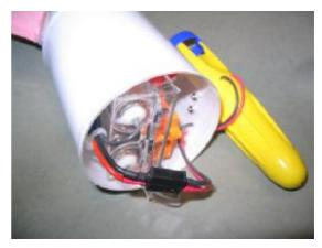
パイプ、コード、2mmビスを通したところは水が漏れないようにセメダイン EP001N で内外からシールしておきます。以上の作業が終ったら仮組みをばらしロッドにグリース(シリコングリースが良いと思います)を付け、再度組み立てます。
