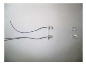
バネ鋼で曲げ難いですが横に出た部分を内側に折り曲げ、そこに線材を結び付け半田付けします。 それを2穴の端子板に通して接着します。接着剤はセメダインの EP001N を使いました。穴の径は図では2mmになっていますが使う線材に合わせて広げて下さい(上右の写真)。
