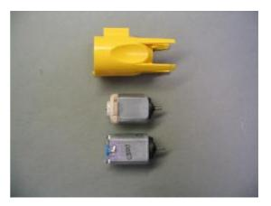
水中モーターの組立ては、モーター部分は接着剤(今回はエポキシレジンを使いました)で固め、電池の入る部分にはグライダー用のウエイト(鉛球)に接着剤を混ぜ積めました。モーターはレジンで固める前にノイズキラーコンデンサーをつけておきます。次ページ左の写真はモーター部分を組立て上下に圧力を掛けパッキンを潰した状態でエポキシレジンを流し込み固めているところです。また次ページ右の写
