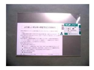
その他の部品はt=2.0mmのPETの板(上右の写真)を使用して製作しました。塩ビでもスチロールでも構いませんが、アクリルは割れやすく加工し難いので避けた方が無難です。
