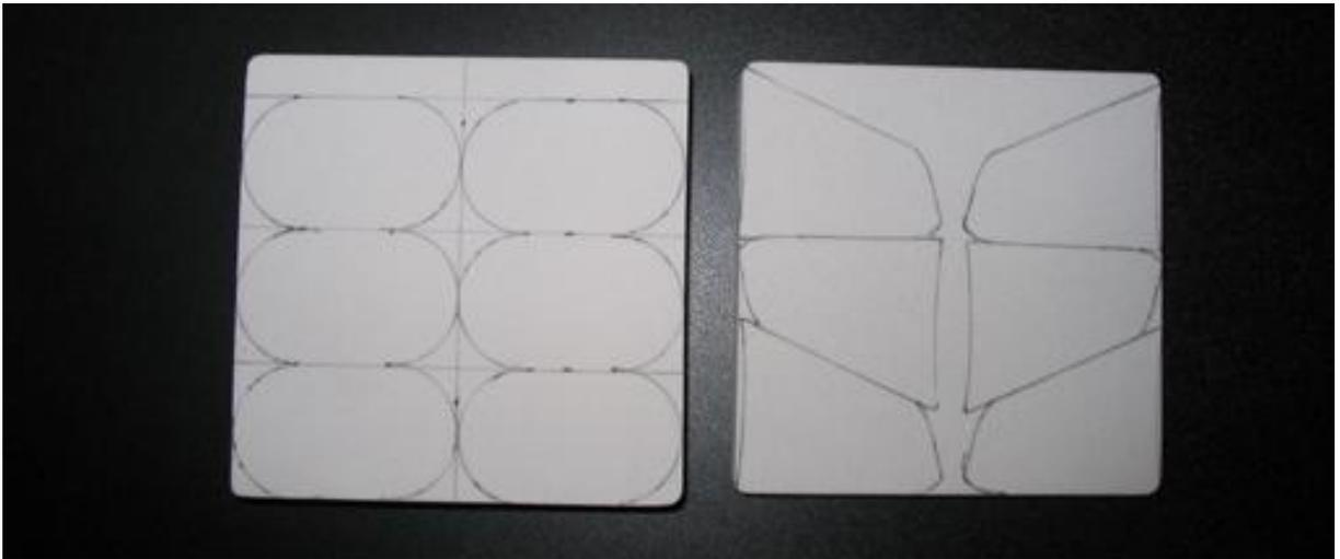
カットは目の細かいのこぎり(下左の写真:ホビーのこ)で切れます。細かい加工は良く切れるナイフで少しずつ切り込んで行ってください。力を入れると思わぬ怪我をしますので注意して下さい。ソナー部のペットボトルとの接着面はボトルに合わせ凹ませておきます。ペットボトルより細身のスプレー缶のような丸い物に両面接着テープで#150程度の紙やすりを貼った物(下右の写真左側)を使うと便利です。また、四角の木のブロックに紙やすりを貼った物(下右の写真右側)で角を丸めておきます。
