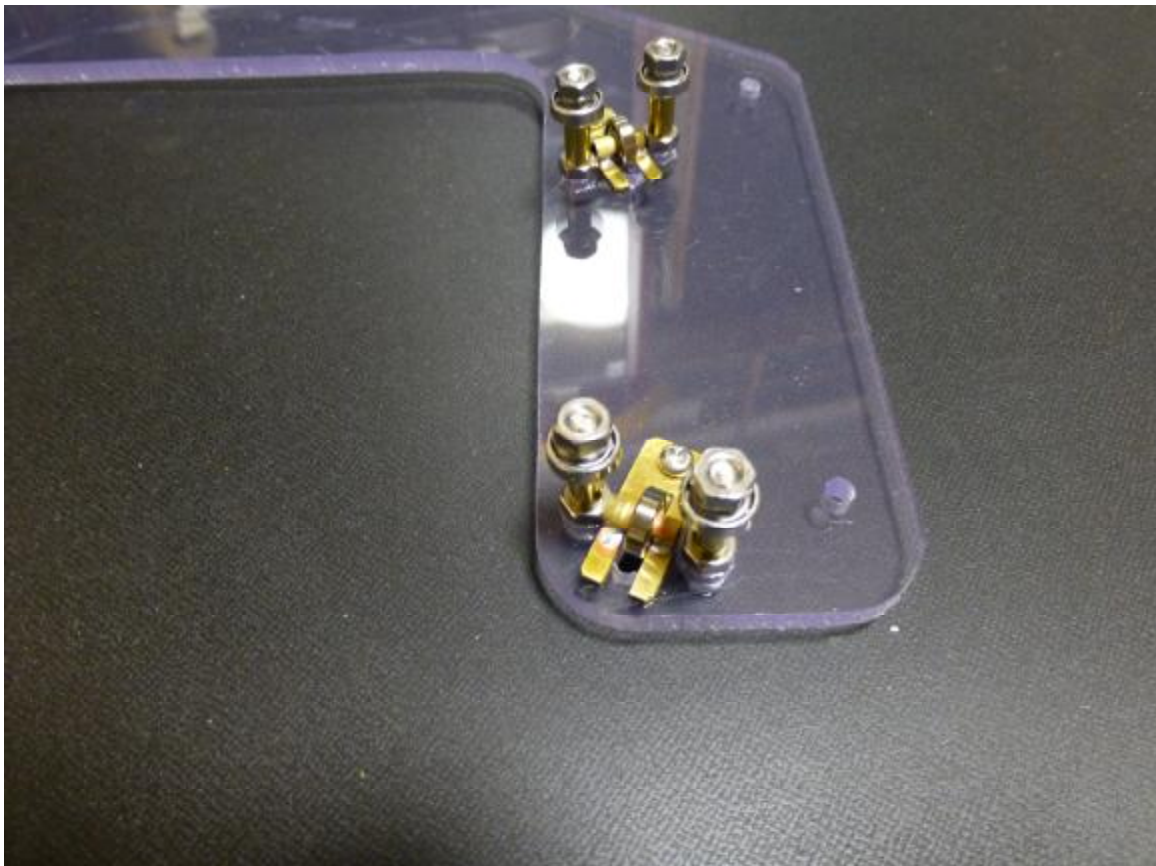
写真2. 4 ベアリング取付状態
