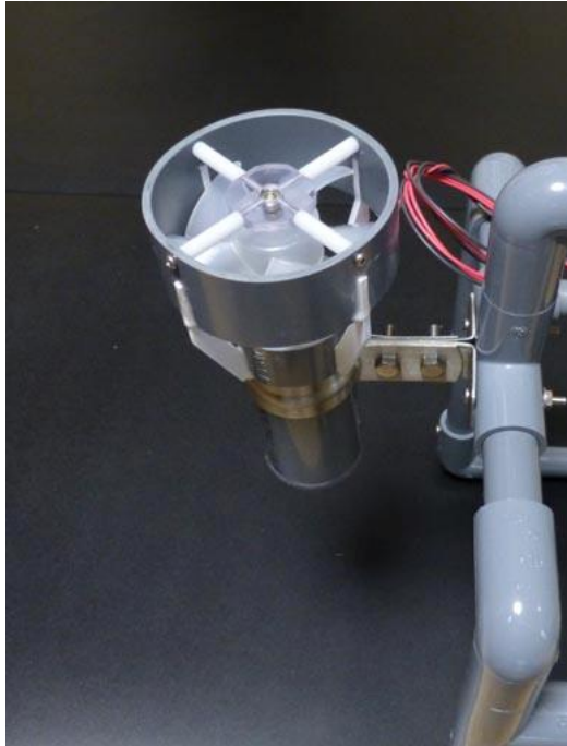
写真3. 1 垂直方向のスラスタ取付
