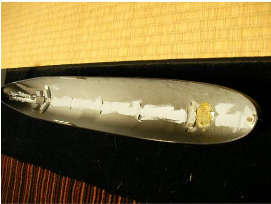
船体はほとんど補強せず中に汎用W T Cを入れて走らせました。しかし遊んでいると操縦ミスなどによりプールの壁にぶつかることがあります。スピードが出ていなくてもおよそ 1mm 強の厚さの船体は接着箇所から破折していきます。
