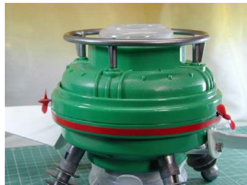
動力性能向上型「潜水Q」。単3電池仕様になり、スクリューとフィンの大型化を図った。
