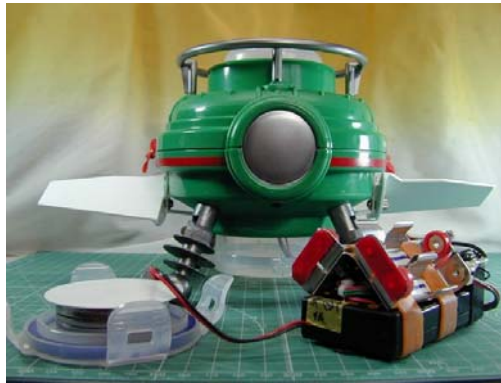
動力性能向上型「潜水Q」。単3電池仕様になり、スクリューとフィンの大型化を図った。
