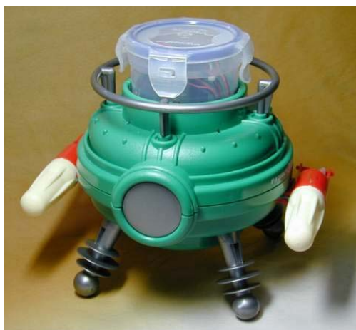
「潜水Q」最初期のバージョン。ラジコンで左右の水中モーターをコントロールする
