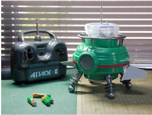
改良型「潜水Q」。当初は単4電池仕様であった。水深3メートル付近まで潜航可能。 モーターをボディ内に収め、スクリューのみ外へ。
