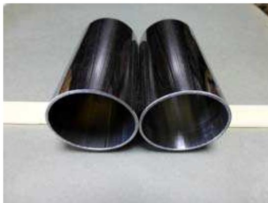
片方の端面をφ6mmの真鍮パイプを付けた真鍮板で蓋をします。ステンレスの半田付けは大きめの鋺でフラックスさえ付ければ極めて容易に付きます。半田付け後フラックスを綺麗に洗い流さないと錆が来るので注意して下さい。
