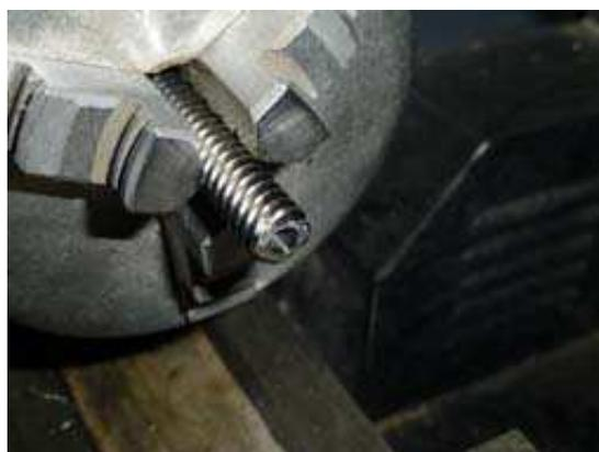
下の写真は 380 モーターとタミヤの遊星ギヤを組み立てたものに多条ネジを取り付けた状態を示します。止めネジが多条ネジの谷部より低いので、ナットを遊星ギヤの端面まで移動させることができます。
