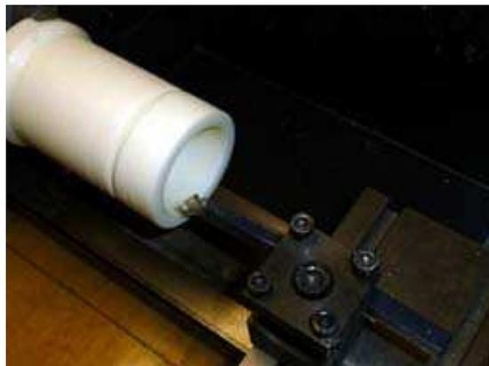
最後に突っ切りバイトで突っ切ります (下左写真)。切断後のピストンを下右の写真の右から 2 つ目に示します。同様に他の部品も作ります。写真の一番右はアクリルパイプ製のシリンダの端面用で  $t=8\text{mm}$  の円盤です。左から 2 つ目はシリンダのもう一方の端面で多条ネジのナットを取り付けます。一番左は多条ネジの端面を支える板で中心に NSK マイクロプレジジョンのフランジ付ミニチュアステンレス玉軸受け SMF148ZZ をは嵌め込みます。
