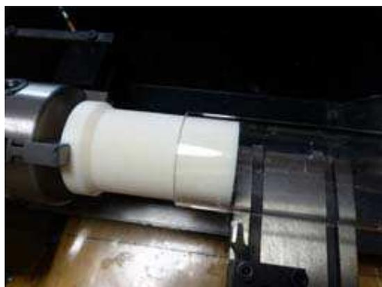
次に O リングの溝を掘ります。O リングは、最初 NOK の P48 運動用 (D=54mm) を使う積もりでしたが、P46 (D=52mm) を引き伸ばして使った方が滑りが良く、漏れも少なそうなので変更しました。太さが  $3.5 \pm 0.1\text{mm}$  なので、突っ切りバイトで幅 3.5mm、深さ 3.4mm 程度の溝を掘りますが、ここもやはり現物合わせで削ります (下左写真)。往復運動をさせるため余り固くては駄目ですが、緩過ぎても漏れるので適当な固さにします。端面に太目の穴を開け、中ぐりバイトで  $\Phi 41\text{mm}$  まで広げていきます (下右写真)。
