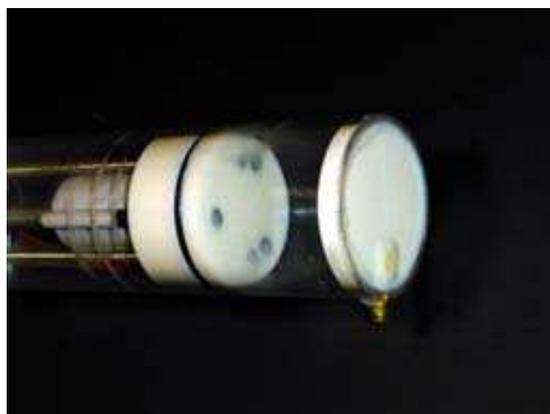
ガイド用のΦ5mmのステンレス丸棒の最終端は分解できるよう止めネジで固定しました。多条ネジの端部はミニチュアステンレス玉軸受けSMF148ZZで回転できるようにしています。
