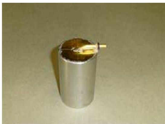
ピストンはABS製で、旋盤で現物合わせで削ります。最初にガタなくスムーズにシリンダーに入る外形に仕上げ、次にOリングの溝を突っ切りバイトで削りました。OリングはP35.5(太さ3.5mm×外径42.2mm)を使用しました。材料を旋盤から外さずOリングを装着しアタリを見ながらの作業です。
