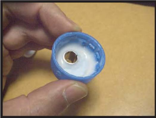
キャップを一度はずして内部にEP001を盛り上げるように塗ります。この接着剤で隙間を完全に塞いでシールします。
