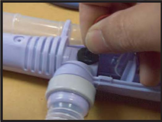
リード線のゴムケーブルを押し込みながら、電池ケースとチューブ部分を分解します。
