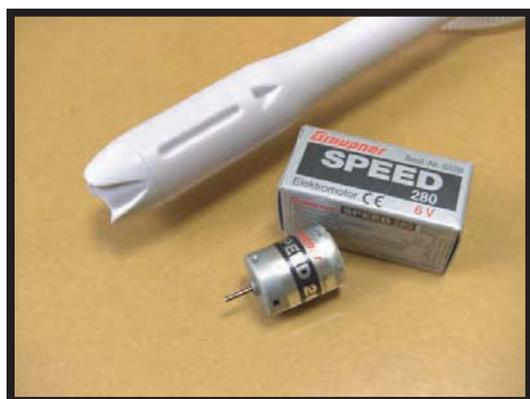
必要なのはポンプの先端部です。この中にあるモーターを換装して使用します。
