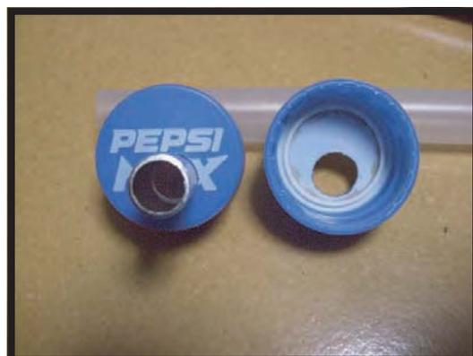
キャップにドリルで穴を開けていきます。この時径の小さいドリルから太い物へ何段階かわけで開けると開けやすいです。開ける位置は写真を参考にしてください。
