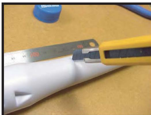
ポンプ部分を必要な部分に分けるためにカッターでパイプを切断します。
