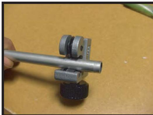
次に噴射ノズルになる10mm径のアルミパイプを1.5~2.0cmにカットします。
