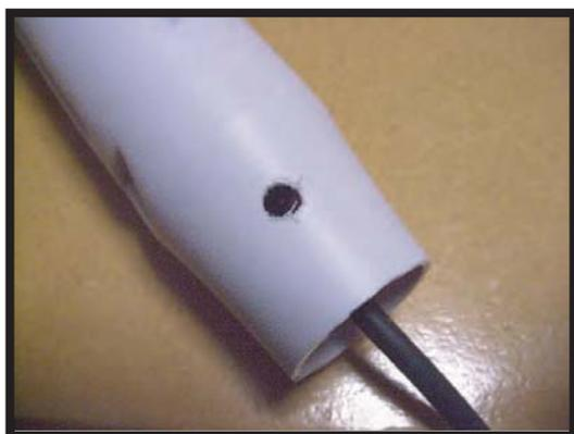
ポンプの後ろ端から1.5cmの所にドリルで穴を開けます。モーターからのコードが直径にあわせた穴をあけてください。
