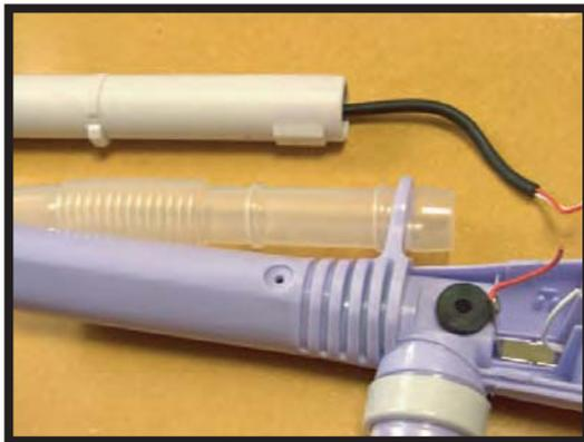
押し込みながらはずすと簡単にチューブと電池ケースが分解できます。
