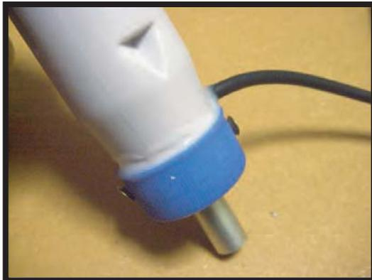
キャップをしてネジ止めしてキャップと本体との隙間に更にEP001を流し込みます。モーターコードの部分にもEP001を塗って隙間うめを行います。塗り終わったら真上に向けてそのまま数時間放置してEP001が固まったら完成です。
