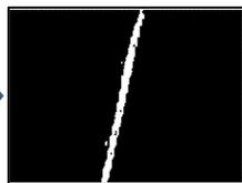
Hough変換を用い、ラインと機体の角度を出力。
